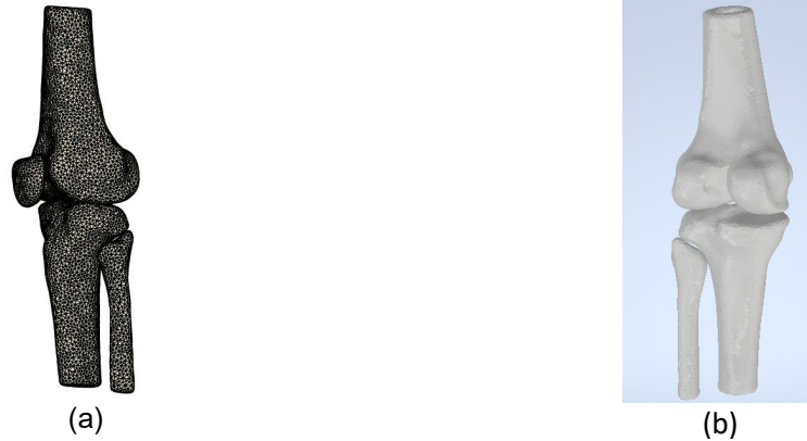
Figura N° 8. Articulación de rodilla. Generación de superficies a partir de triangulación (a). Modelo sólido suavizado (b).
