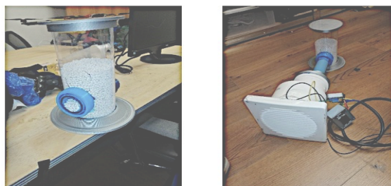
Fig. 7: Montaje del prototipo del sistema de extracción y retención de CO 2 [Fuente: propia]
