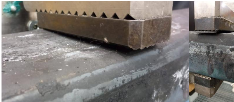
Figura 3. Espacio anormal entre los dedos de las pinzas neumáticas y la pieza que se está sujetando.
