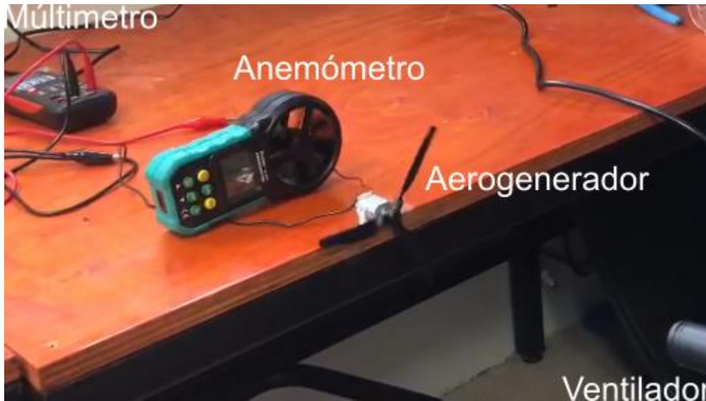
Figura N° 2. Disposición de los aparatos e instrumentos para la medición de las variables de interés. Experiencias desarrolladas en el Innovalab de la Facultad de Ingeniería de la Universidad Autónoma de Chile.
